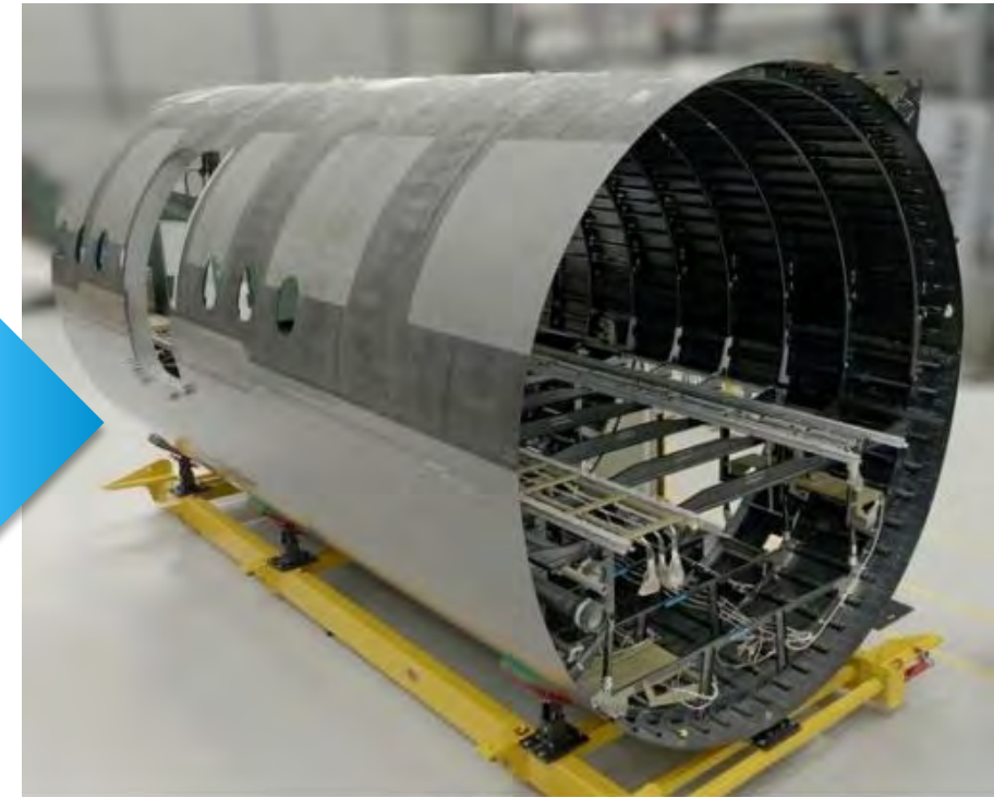
8 Meter lange Rumpfsktion mit 4 Metern Durchmesser, komplett auf VICTREX LMPAEK™ Polymer Basis
