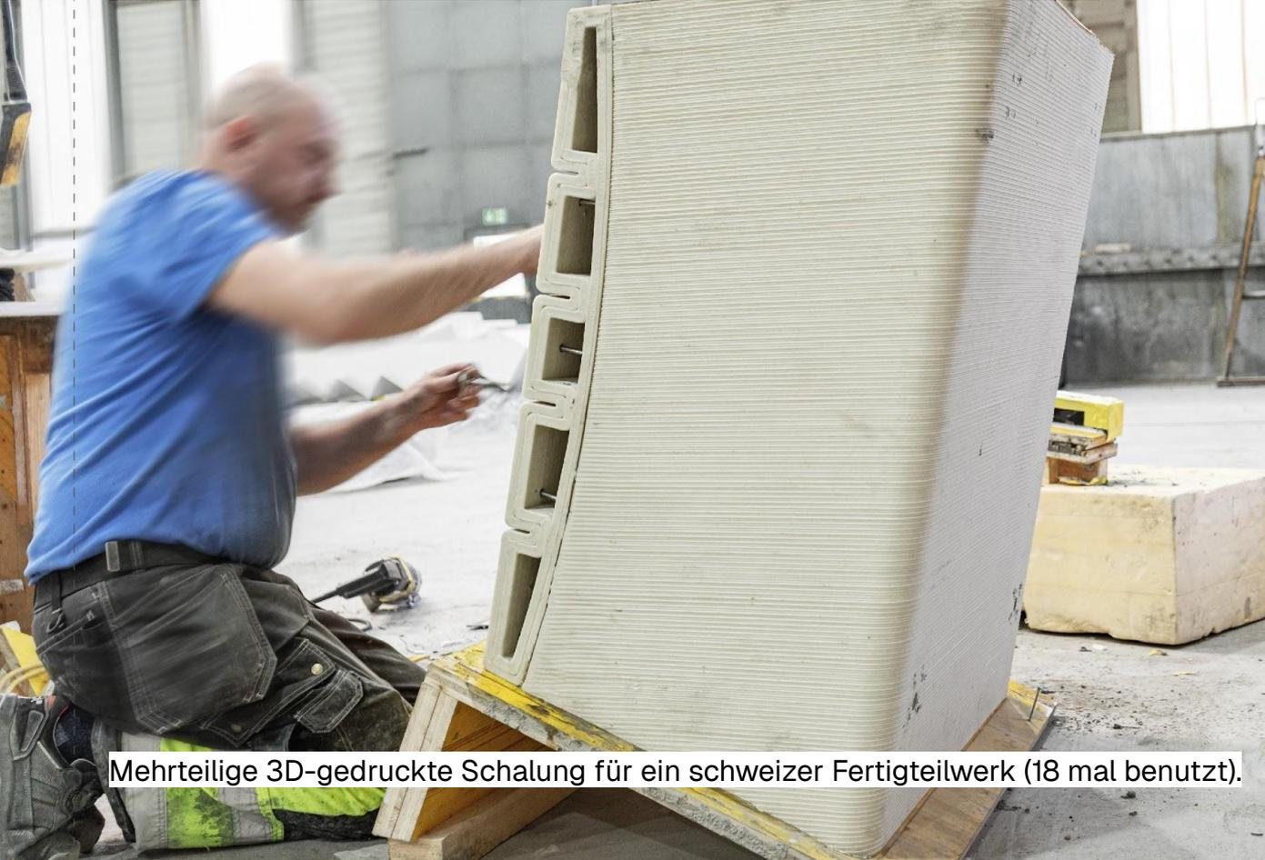
Mehrteilige 3D-gedruckte Schalung für ein schweizer Fertigteilwerk (18 mal benutzt).
