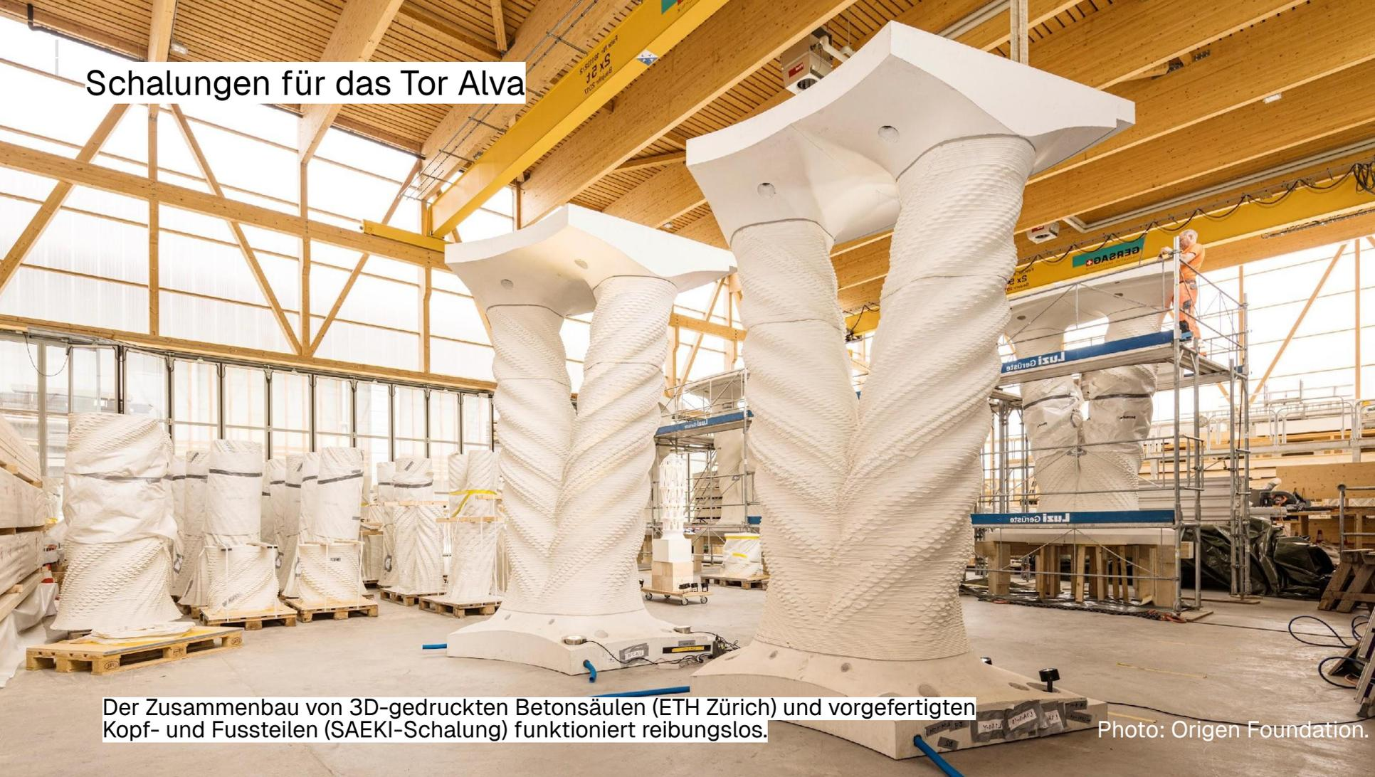
Der Zusammenbau von 3D-gedruckten Betonsäulen (ETH Zürich) und vorgefertigten Kopf- und Fussteilen (SAEKI-Schalung) funktioniert reibungslos.
