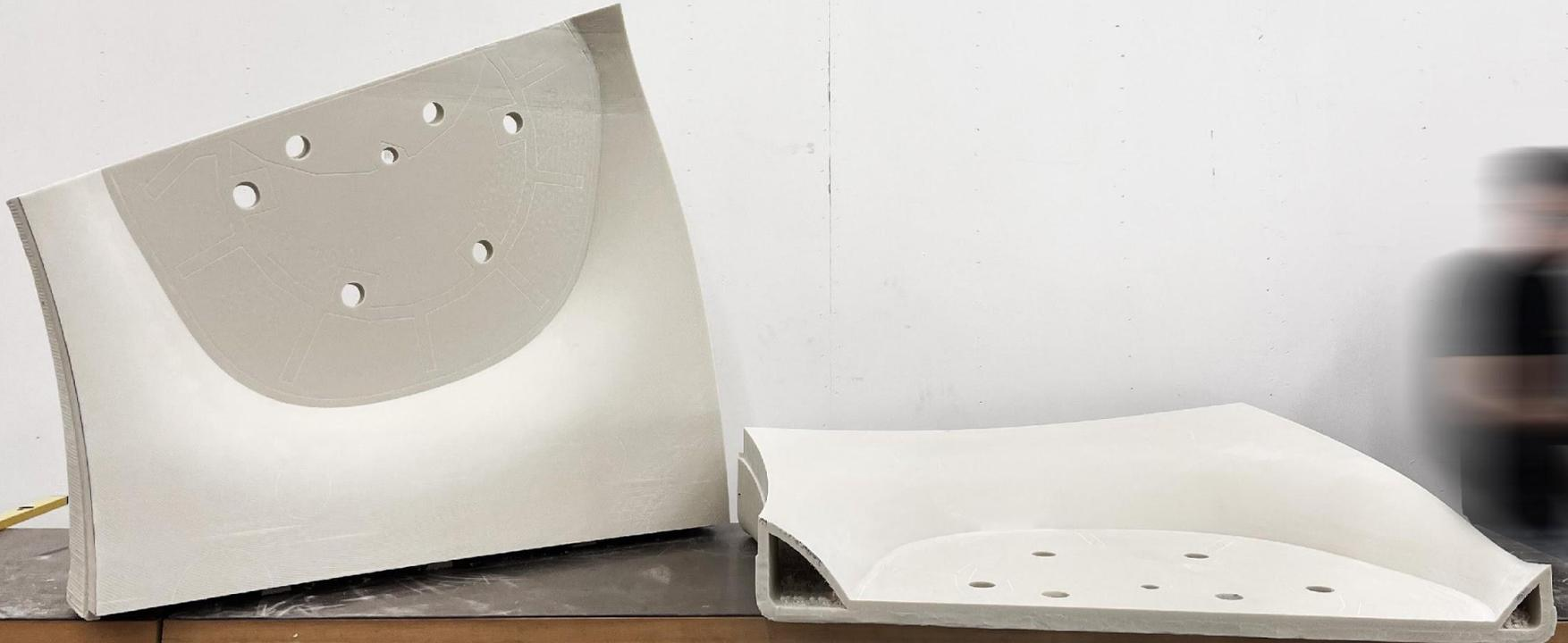
Grossformatige 3D-gedruckte Schalung für Sockel und Kapitell der Säulen, ABS mit Glasfasern.
