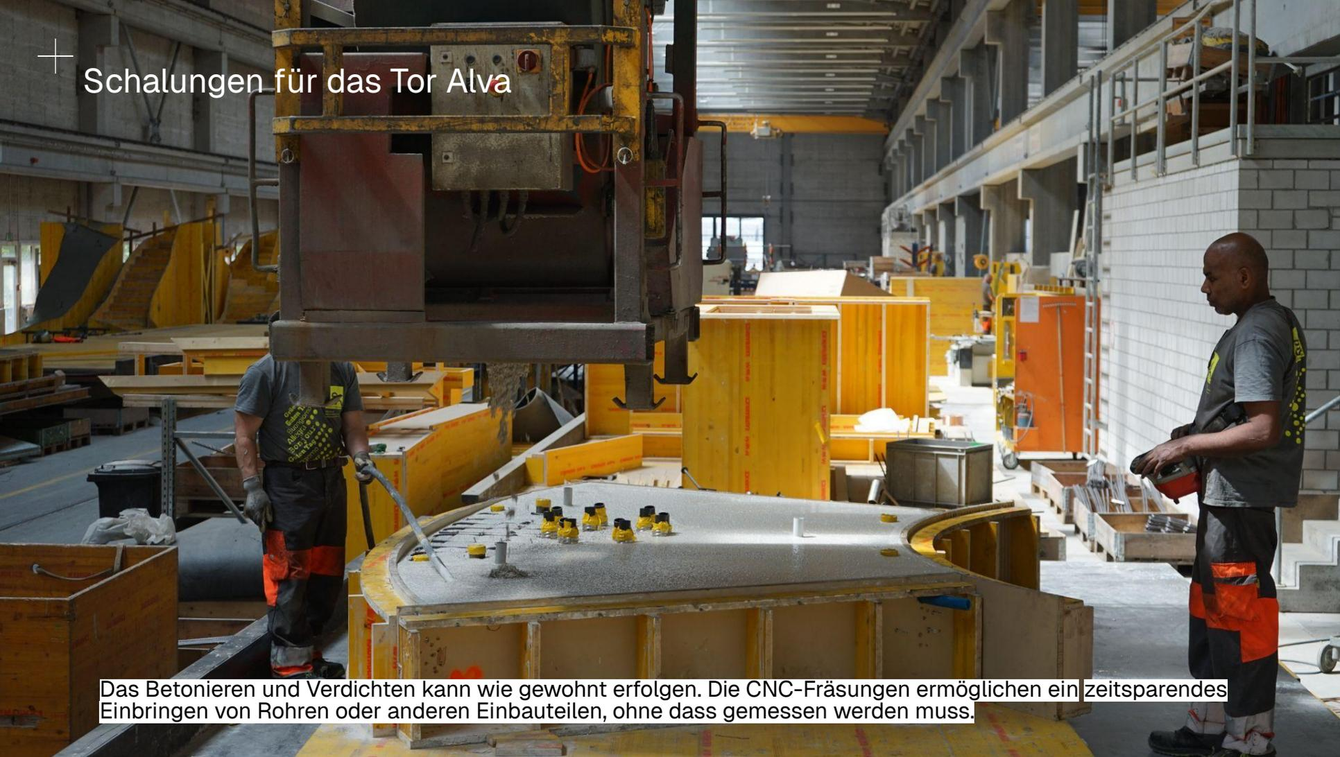
Das Betonieren und Verdichten kann wie gewohnt erfolgen. Die CNC-Fräsungen ermöglichen ein zeitsparendes Einbringen von Rohren oder anderen Einbauteilen, ohne dass gemessen werden muss.
